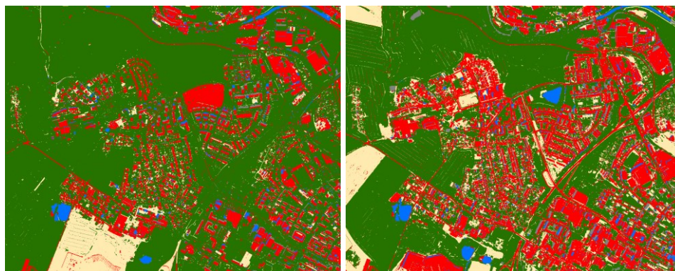
Obr. 28 Objektově orientovaná klasifikace, klasifikátor KNN, m. l. JIHL84, vlevo pro rok 2020, vpravo pro rok 2022
