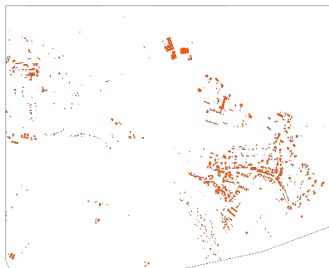
Obr. 126 Extrahované budovy z klasifikovaného mračka bodů, m. l. ZNOJ57
