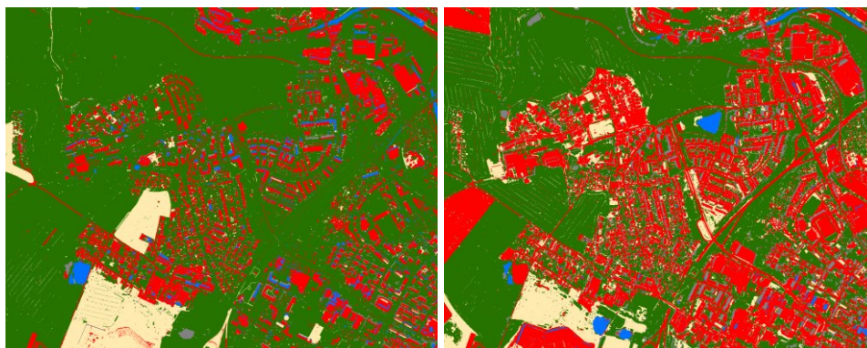
Obr. 30 Objektově orientovaná klasifikace, klasifikátor RT, m. 1. JIHL84, vlevo pro rok 2020, vpravo pro rok 2022
