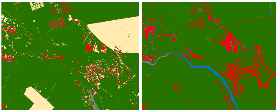
Obr. 121 Objektově orientovaná klasifikace, klasifikátor SVM, m. 1. ZNOJ57, vlevo pro rok 2020, vpravo pro rok 2022
