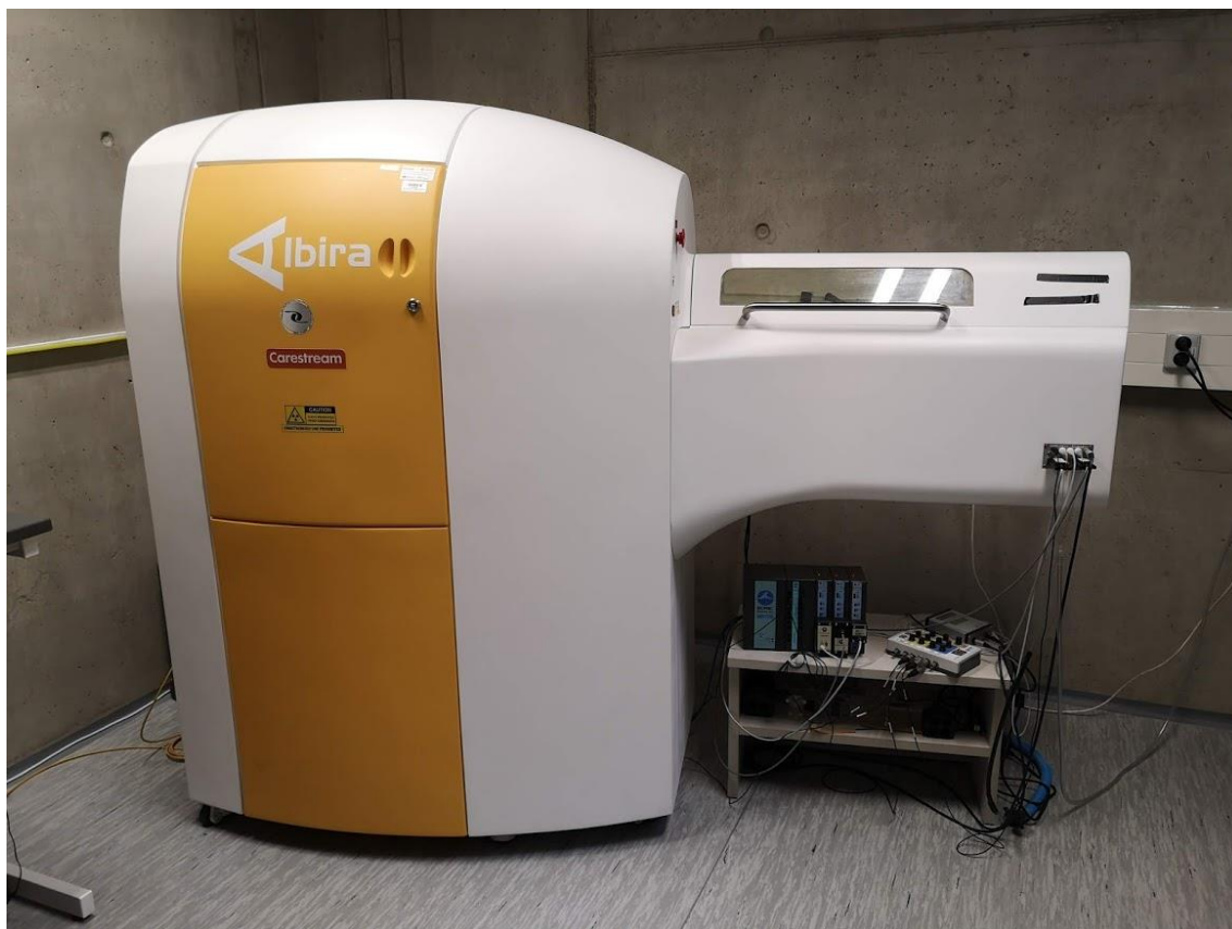
Obr. 8 Prístroj Albira pre PET/SPECT/CT zobrazovanie laboratórných zvierat. V pravej časti prístroja je umiestnené lôžko pre laboratórne zvieratá, ktoré sa počas samotného snímania presunie do ľavej časti, kde sú umiestnené konkrétne zobrazovacie zariadenia. Prístroj je napojený na systém inhalačnej anestézy. Foto: Hajduová Katarína
