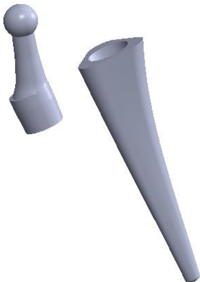
Obr. 29: Model geometrie totální endoprotézv Maïa
