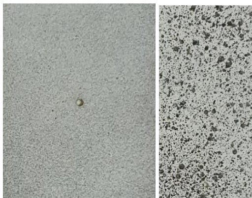
Obr. 4.2: Stochastický vzor, vytvořený nástřikem černé barvy na bílém podkladu. Obrázek pořízen z experimentálních vzorků.
