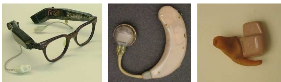
obr. č. 8 zleva – brýlové sluchadlo Sonotone 1955, první sluchadlo BTE (záušní) od firmy Zenith nazvané „Diplomath“ 1956, první zvukovodové sluchadlo od firmy Otariion ECA-1 1961 ( http://beckerexhibits.wustl.edu )
