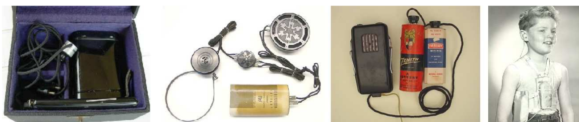
obr. č. 6 zleva – uhlíková sluchadla Siemens & Halsche A-G 1910 a Acousticon 1927, sluchadlo Western Electric 1944, kapsy s popruhy vyvinuté pro nošení baterií a mikrofonu 1944 ( www.amber-ambre-inclusions.info , http://beckerexhibits.wustl.edu )
