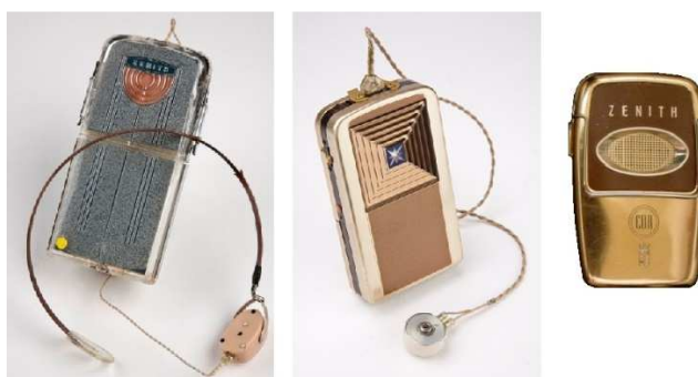
obr. č. 7 zleva – krabičkové elektronkové sluchadlo Zenith s kostním vedením 1947, krabičkové sluchadlo Acousticon 1948, tranzistorové sluchadlo Zenith 1962 ( http://www.northwestern.edu , http://beckerexhibits.wustl.edu )
