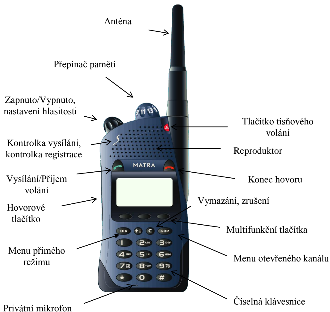
Obrázek P1: Schéma terminálu G2 SMART, zdroj: (35)
