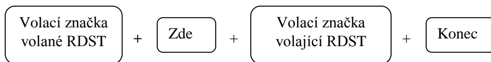
Obrázek 4: Schéma ukončení spojení, zdroj: (13)
