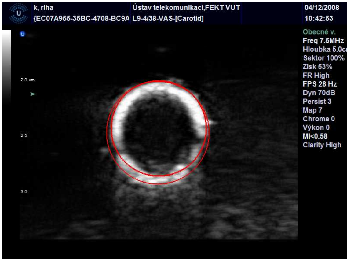
Obr. 5.8: Detekované kružnice ve výsledném obraze bez normalizace.
