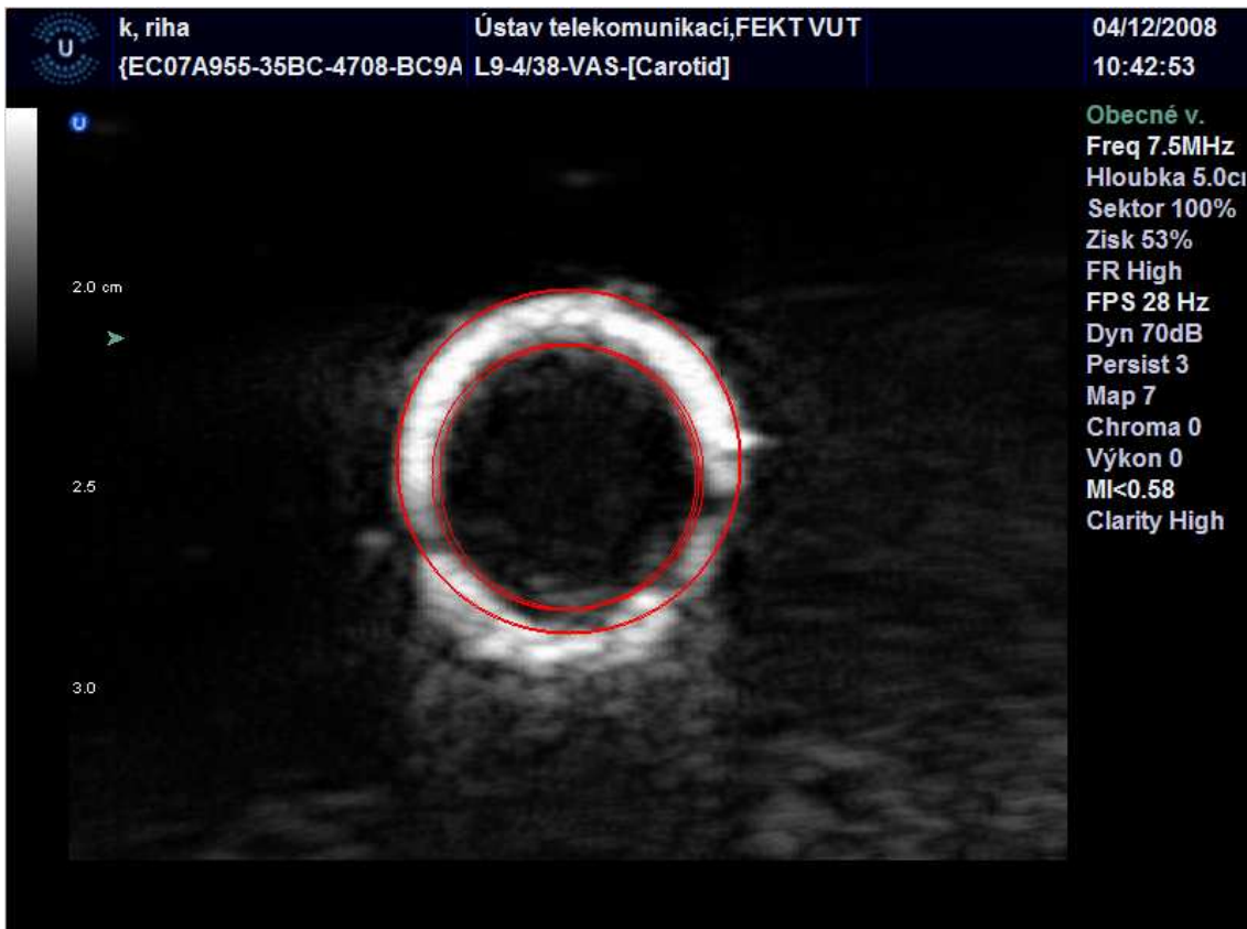
Obr. 5.6: Detekované kružnice ve výsledném obraze s normalizací.
