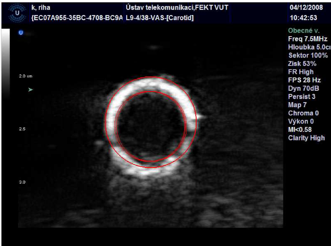
Obr. 5.6: Detekované kružnice ve výsledném obraze s normalizací.
