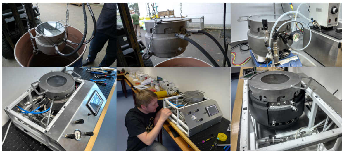
Obrázek 13. Ukázka z průběhu sestavování prototypu uHBK 2
