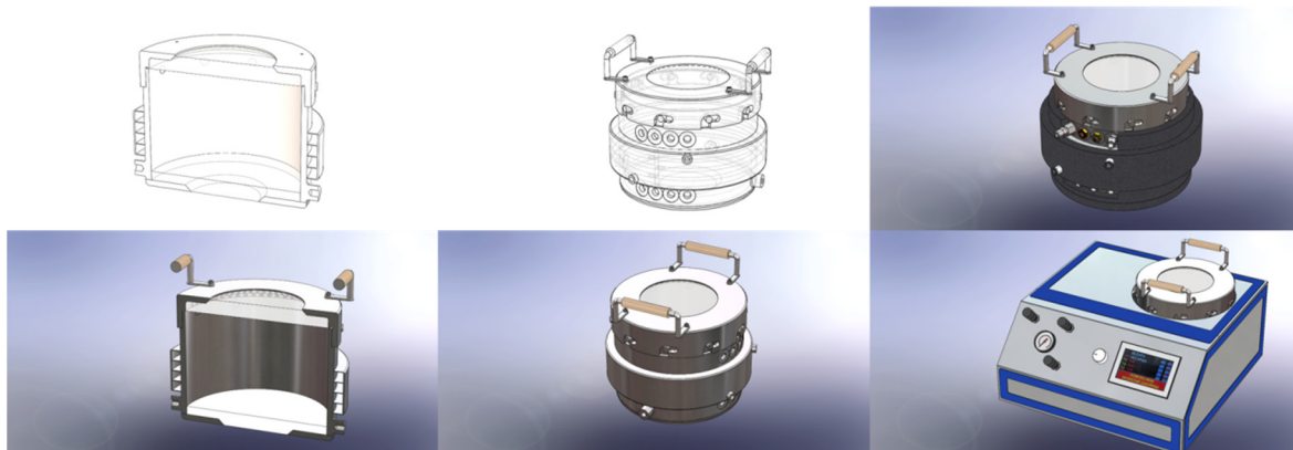
Obrázek 12. Ukázky modelů a vizualizace prototypu uHBK 2 navrženého v software SolidWorks
