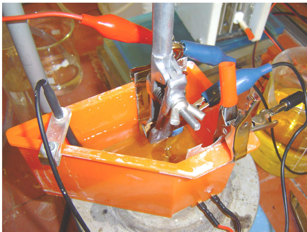
Obrázek 8-5: Foto elektrolytického odmašťování vzorku
