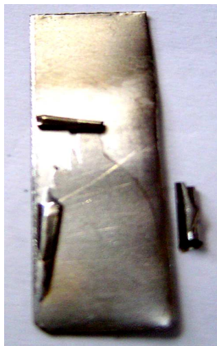
Obrázek 14: Galvanicky nanesená vrstva Ni na niklovém plechu - vliv dlouhé doby pokovování
