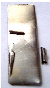
Obrázek 8-8: Foto vyloučeného a znehodnoceného povlaku při dlouhé době pokovování
