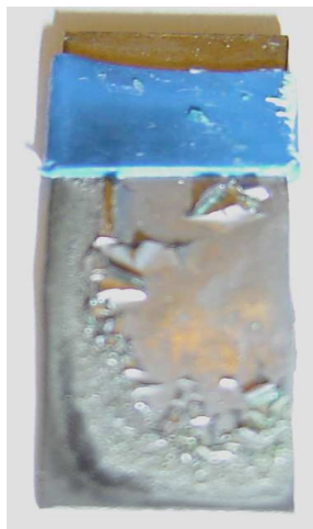
Obrázek 13: Galvanicky nanesená vrstva Ni na mosazném plechu - bez čeření lázně vzduchem, přiváděným pod katodu
