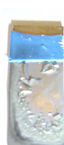
Obrázek 8-7: Foto vyloučeného a znehodnoceného povlaku při nečření lázně
