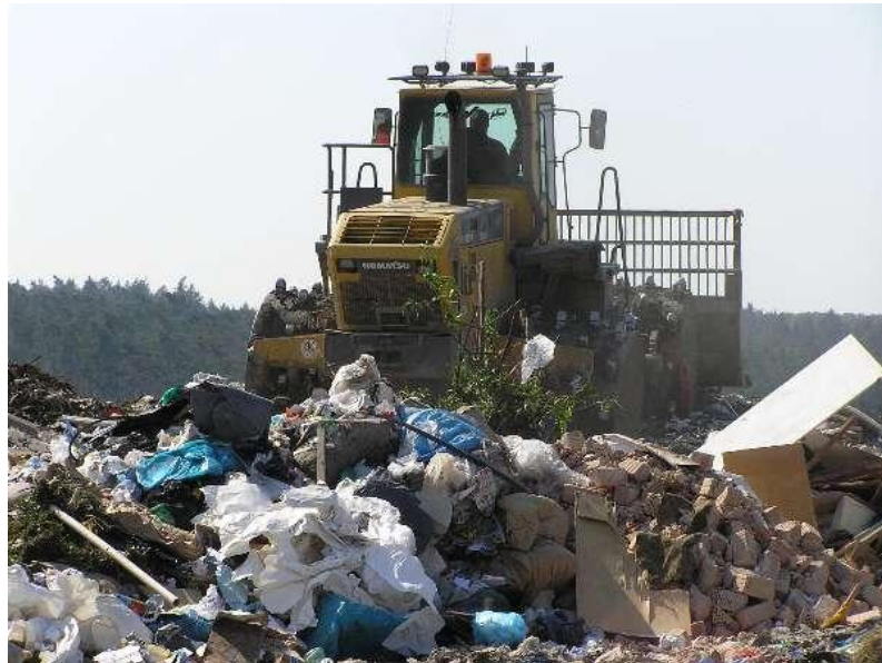
Obr.č. 3: Kompaktor hutníci odpad (ČIŽP, 2008)
