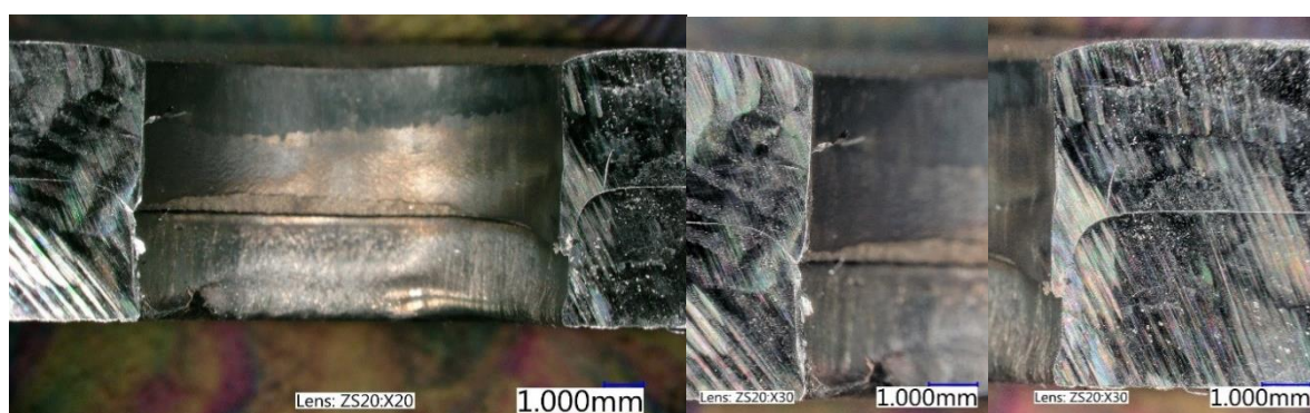
Obr. 52 Příčný řez s detailem na rozhraní vrstev
