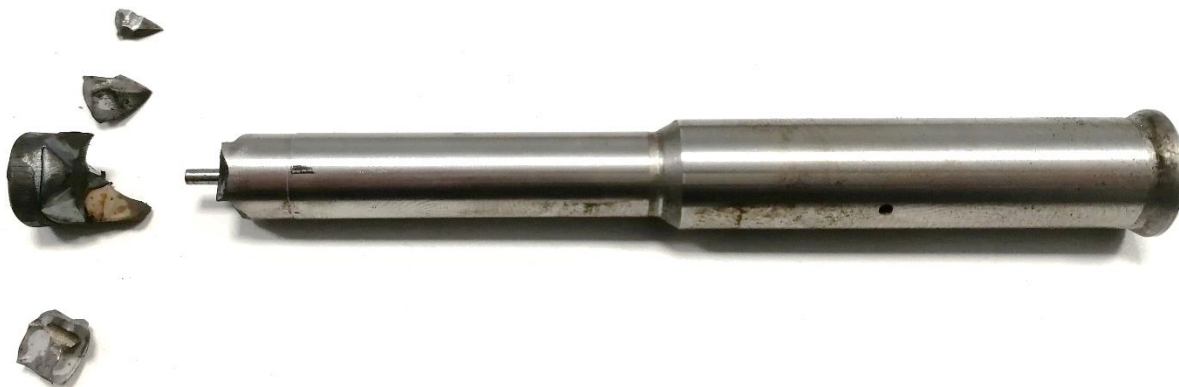
Obr. 56 Střížník s ulomenými hroty a odpadem
