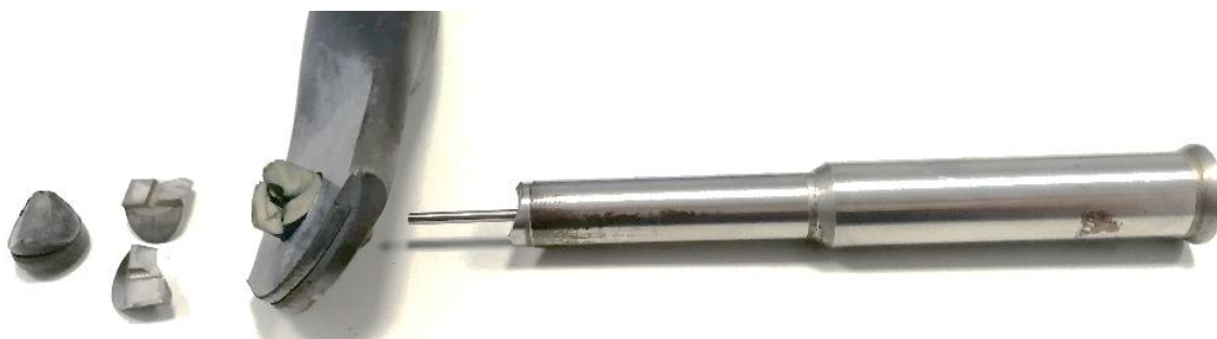
Obr. 54 Odpad a ulomený střížník v stabilizátoru
