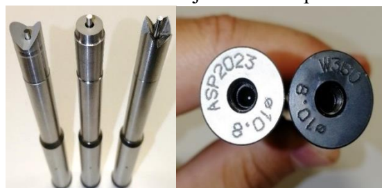
Obr. 47 Úprava čel a označení materiálu
