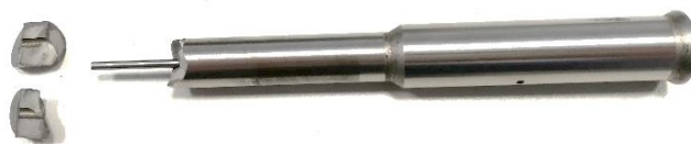
Obr. 53 Ulomený střížník po 1. zdvihu
