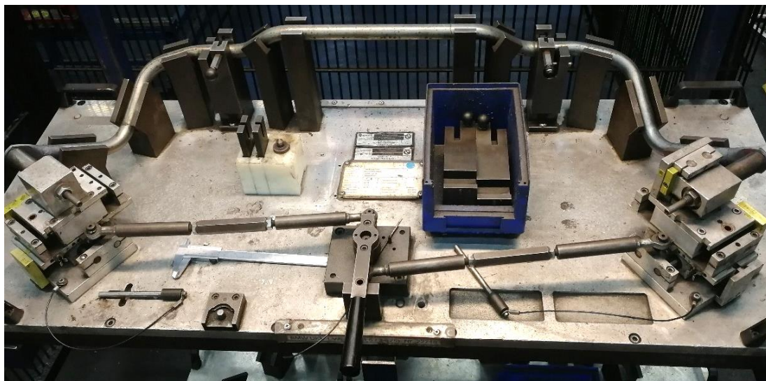
Obr. 50 Speciální měřící přípravek "léhra"
