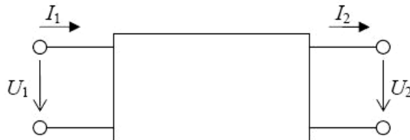
Obr.2.3-2 Dvojbran – označení vstupní brány a výstupní brány
