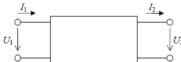
Obr.2.3-2 Dvojbran – označení vstupní brány a výstupní brány
