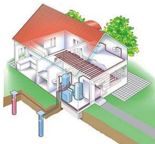
Obr.2.15: Tepelné čerpadlo voda/voda při využití podzemní vody [45]
