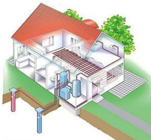
Obr.2.15: Tepelné čerpadlo voda/voda při využití podzemní vody[45]
