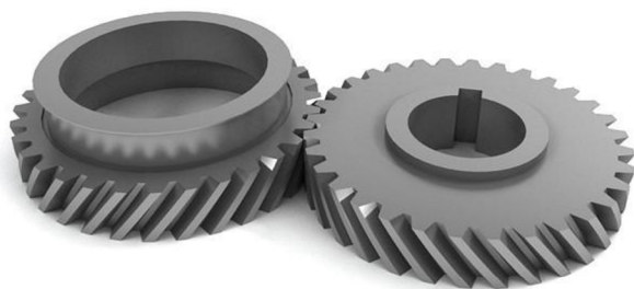
Obr. 26 Čelní soukolí s šikmými zuby [39]
