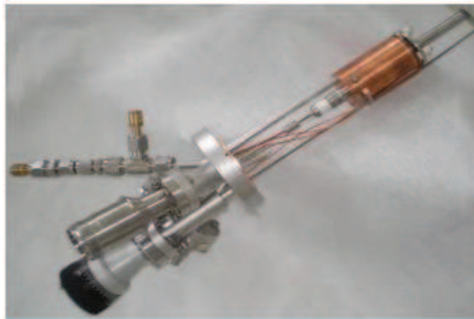
Obr. 3.6 – Efuzní cely. Převzato z [27].
