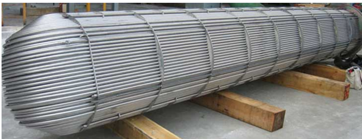
Obr. 2.11 Vlásokový výmenník tepla s U-rúrkami [10]
