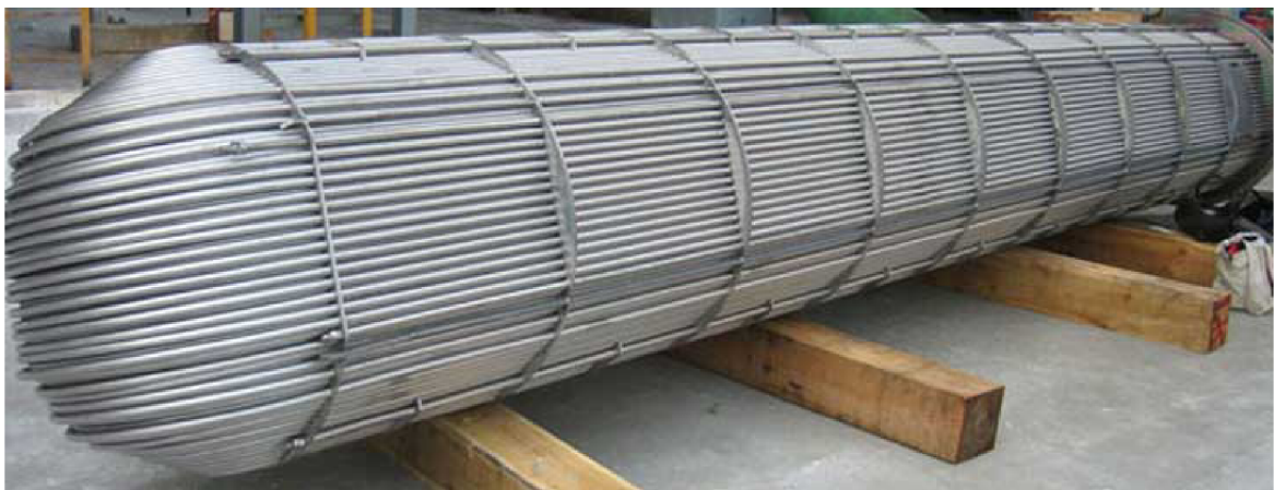
Obr. 2.11 Vlásokový výmenník tepla s U-rúrkami [10]
