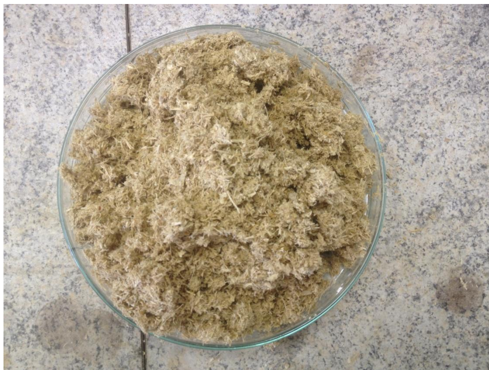
Obr. 14. 5 Biomasa po vylisování (pevná část)
