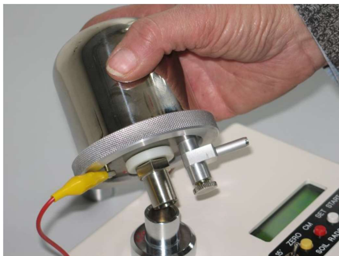
Obrázek 4.7: Detail ionizační komory a VN měřidla systému RM-2
