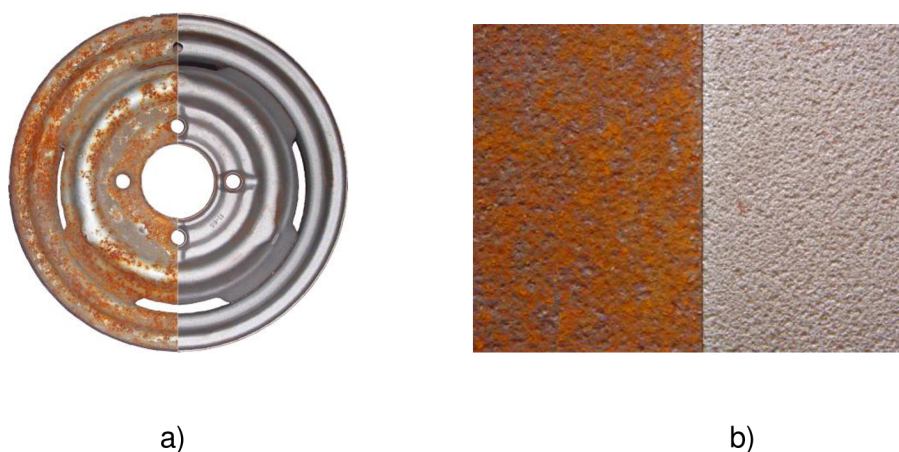
Obr. 38 Příklady využití tryskání : a), b) odstraňování koroze [44]
