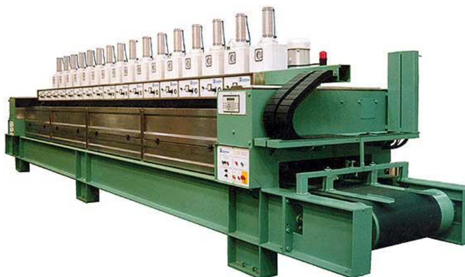
Obr. 18 Kontinuální lešticí linka LCG 600 (COCH S.A.) [15]
