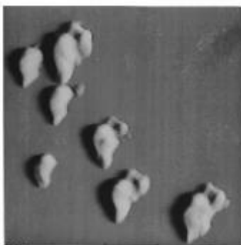
Obr. 9 Příklad zrcadlení hrotu na AFM snímku globulárních proteinů na slídovém substrátu [17]
