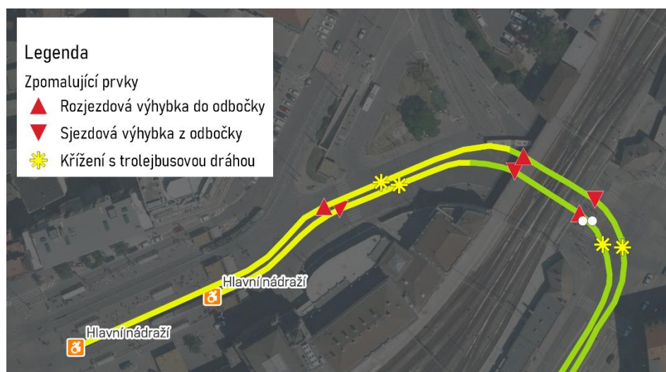
Obrázek 17: Zpomalující prvky mezi zastávkami Hlavní nádraží a Úzká [11]
