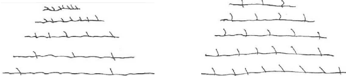
Obrázek 6: Schematické znázornění distribuce bočních větví pro ZN katalyzátory heterogenní (A) a homogenní (B)[7]
