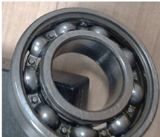
Obrázek 21: Kuličkové ložisko s poruchou
