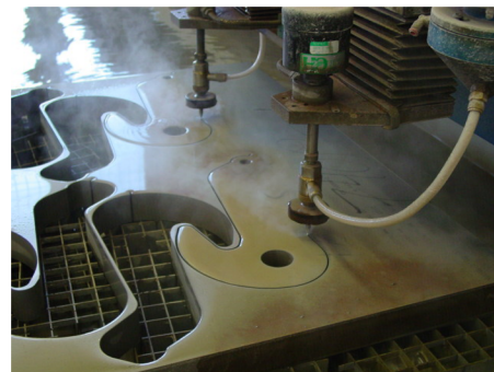
Obr. 6 Řezání vodním paprskem [16]
