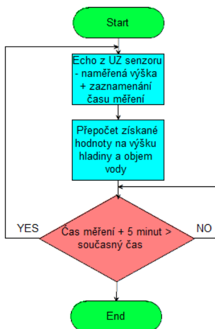
Obrázek 44 - Vývojový diagram měření hladiny [autor práce]
