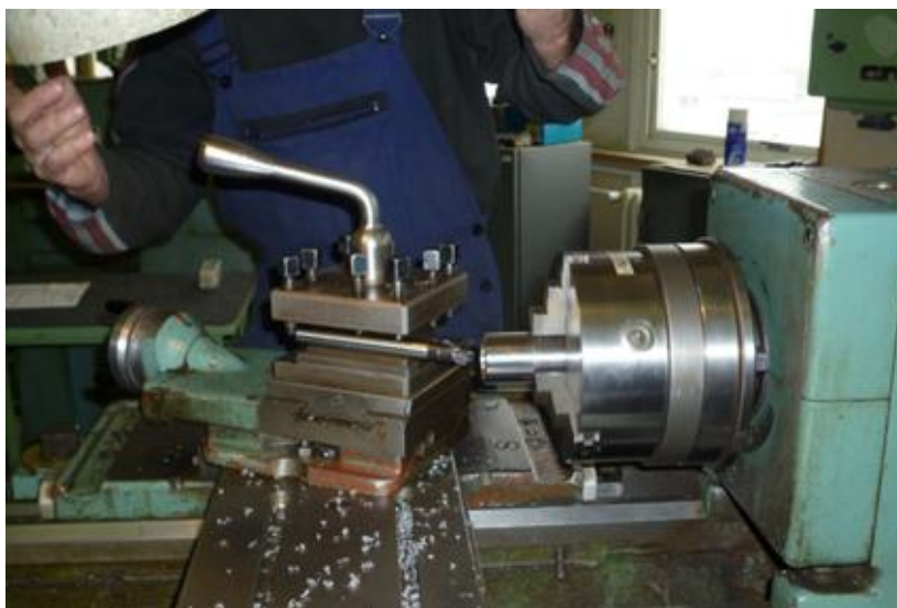
Obr. 4.6 Soustružení vnitřní kuželové plochy součásti.
