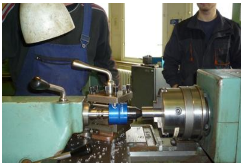
Obr. 4.7 Válečkování vnitřní kuželové plochy.
