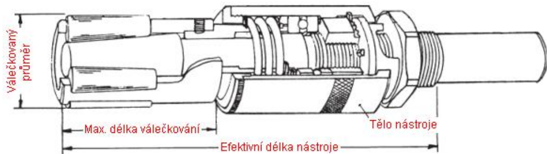
Obr. 2.15 Schematické znázornění nástroje s více tvářecími prvky k válečkování vnitřních válcových ploch 63 .
