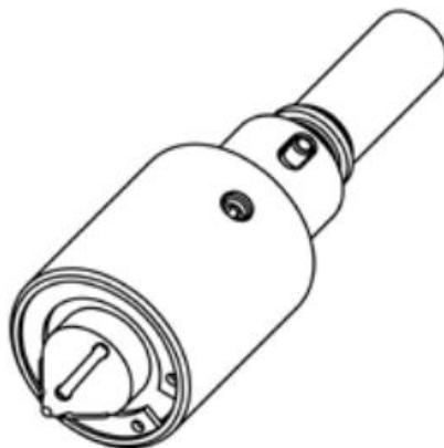
Obr. 4.9 Válečkovací nástroj Baublies IRG-K-3 92 .
