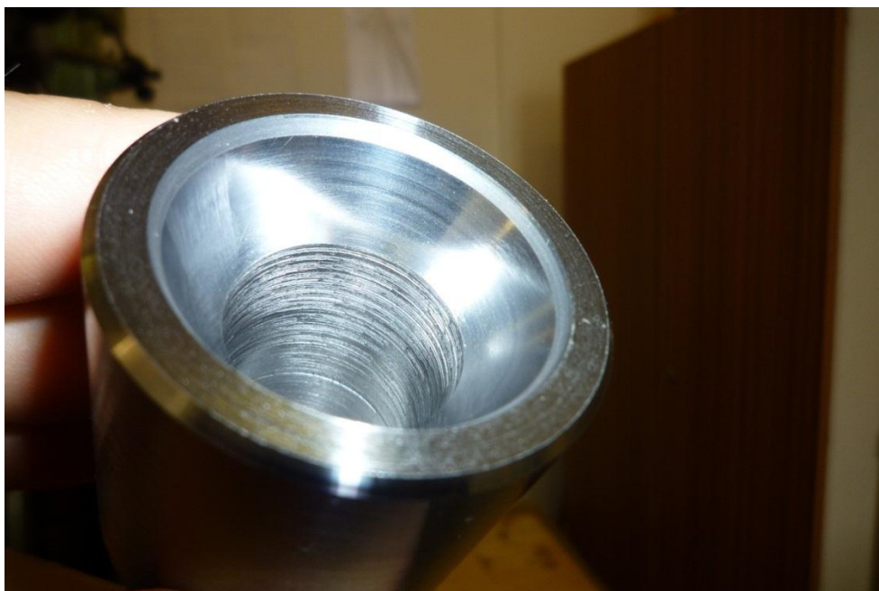
Obr. 4.8 Opracovaná kuželová plocha součásti válečkovacím nástrojem.
