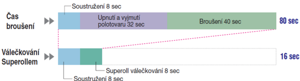
Obr. 6.2 Časová náročnost technologie broušení a technologie válečkování 69 .
