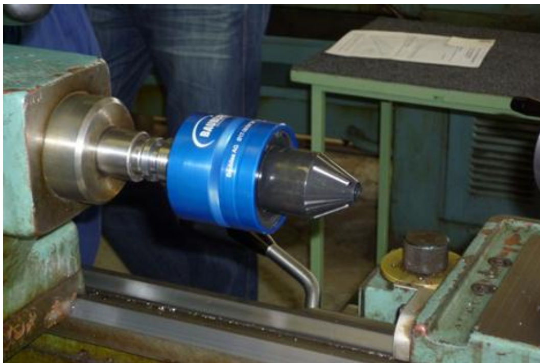
Obr. 4.11 Válečkový nástroj Baublies ERG-K-3 upnutý v pinole koníku.
