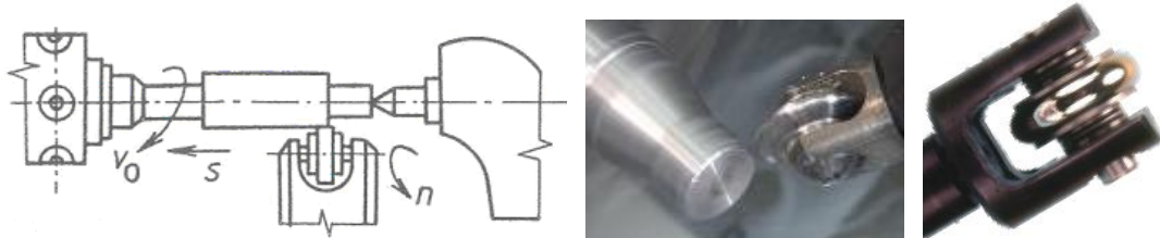
Obr. 2.13 Schematické znázornění válečkování vnější válcové plochy s provedením nástroje s jedním tvářecím prvem 34, 46, 47 .
