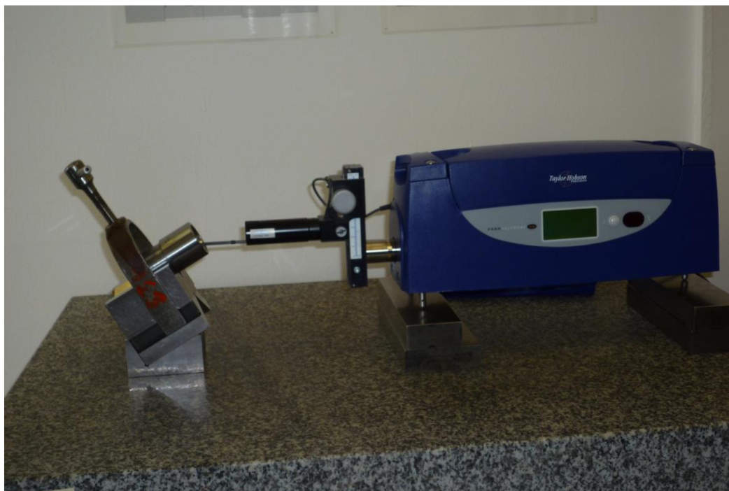
Obr. 4.12 Měření povrchu kuželové plochy součásti dotykovým profiloměrem Form Talysurf Intra.
