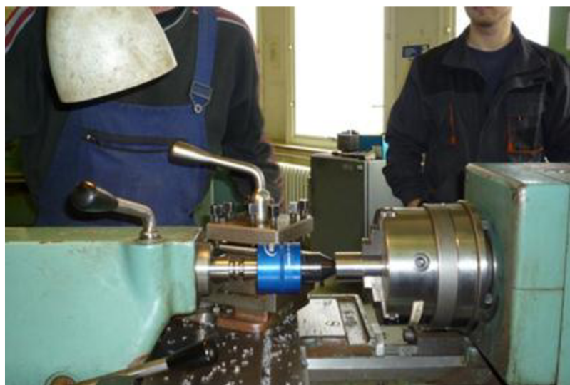
Obr. 4.7 Válečkování vnitřní kuželové plochy.
