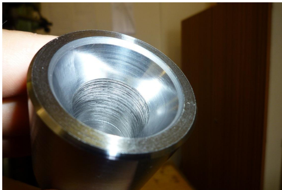
Obr. 4.8 Opracovaná kuželová plocha součásti válečkovacím nástrojem.
