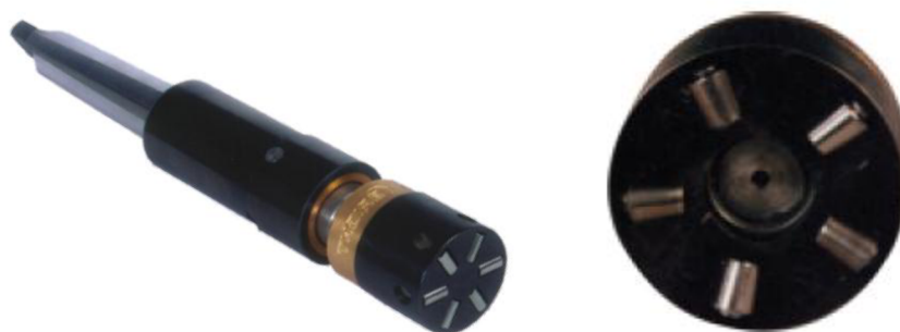
Obr. 2.18 Způsob válečkování čelních ploch a provedení nástroje pro tyto plochy 49 .
