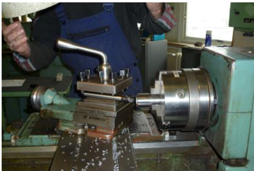
Obr. 4.6 Soustružení vnitřní kuželové plochy součásti.
