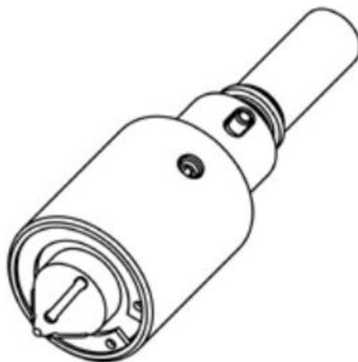
Obr. 4.9 Válečkovací nástroj Baublies IRG-K-3 92 .
