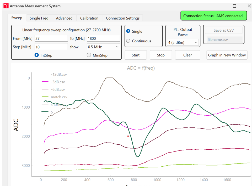
Obrázok 5.9: Činiteľ odrazu 850 MHz antény odmeraný pomocou navrhnutého zariadenia
