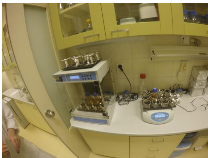
Obr. č. 7: Kultivácia mikroorganizmov na trepačke
