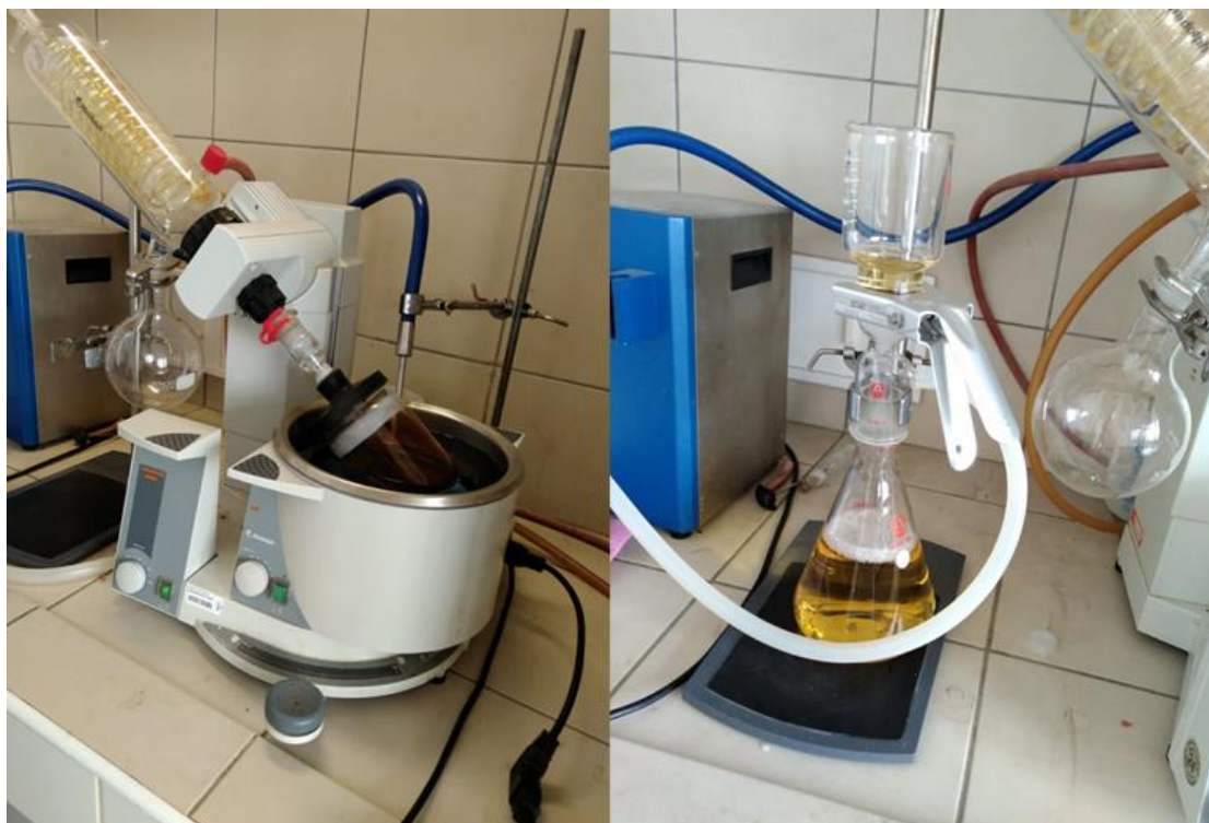
Příloha 1- Vzorek HK na rotační vakuové odparce; filtrace roztoku FK před zahájením dávkování na kolonu
