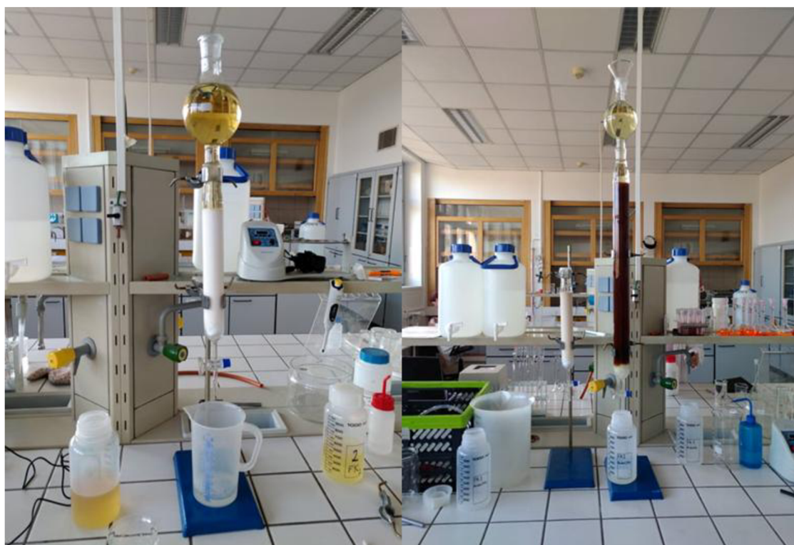
Příloha 2 - Sorpce FK na pryskyřici DAX-8; zpětná protonace roztoku FK pomocí pryskyřice Amberlite
