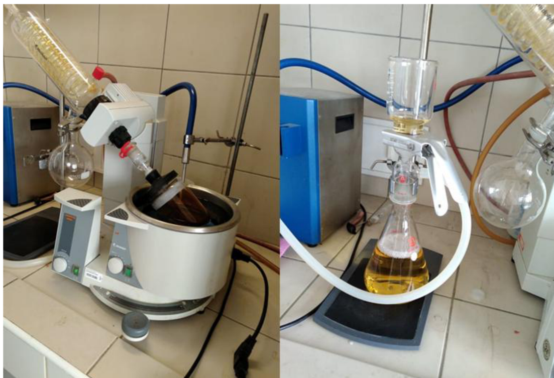
Příloha 1- Vzorek HK na rotační vakuové odparce; filtrace roztoku FK před zahájením dávkování na kolomu
