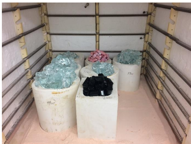
Obr. 48 – Pec, formy naplněné skleněnými střepy
