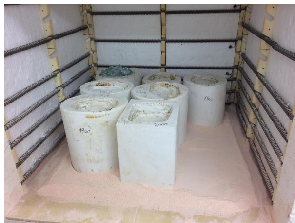
Obr. 47 – Pec, prázdné formy
