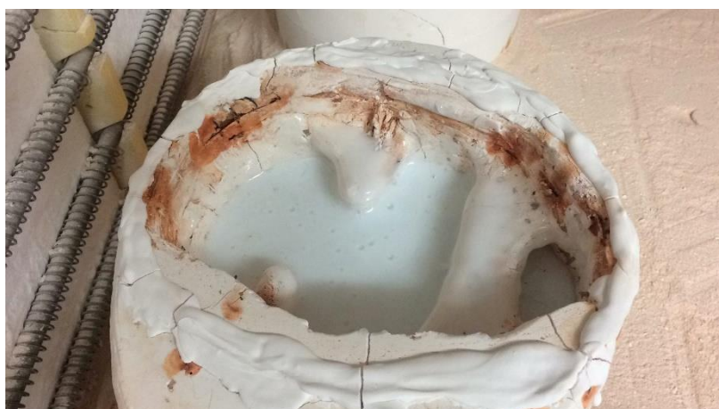
Obr. 50 – Vada, nezatečení skloviny - nedostatečné množství skla
