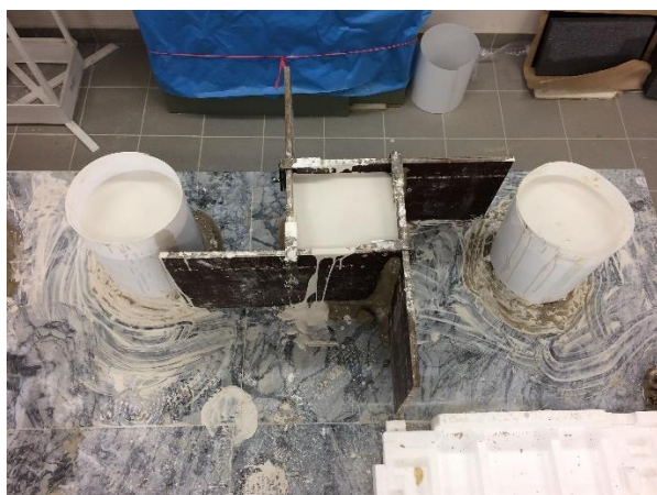
Obr. 39 – Formy, zalití sádrou
