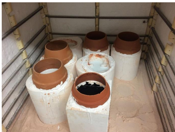
Obr. 49 – Pec, formy po utavení
