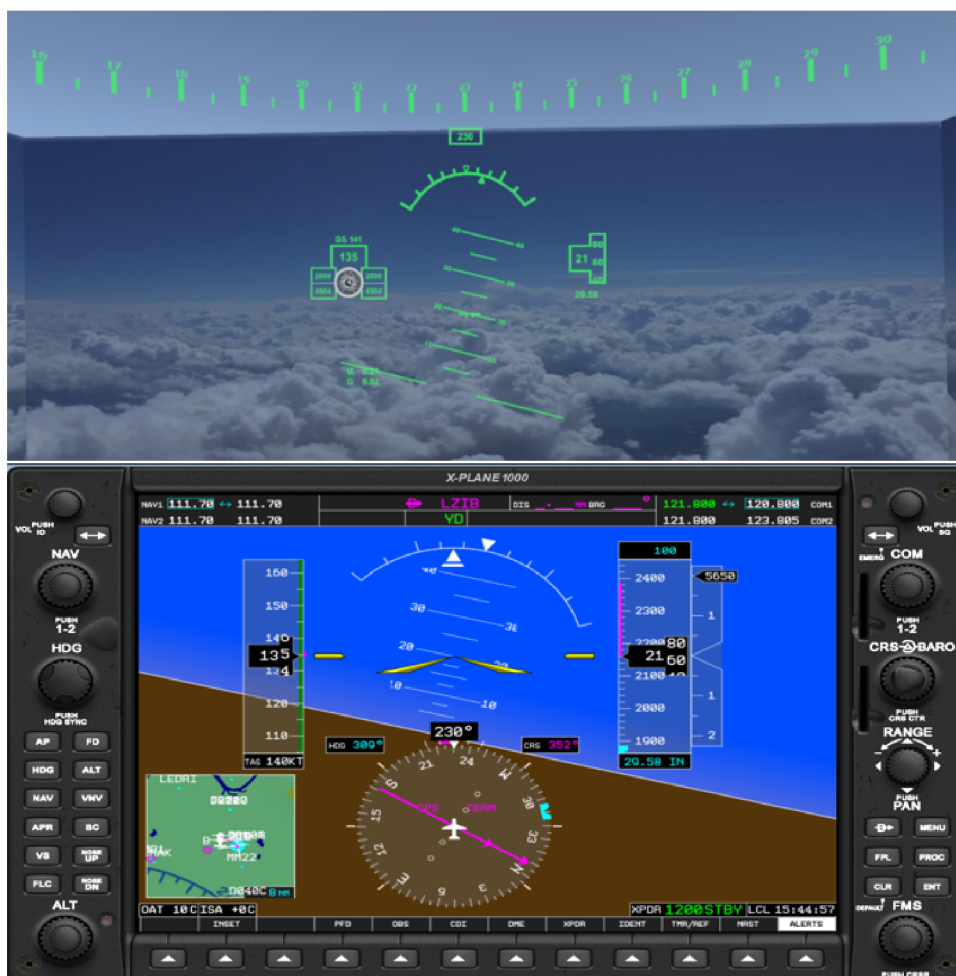
Obr. 6.3: Testovanie HUD na základe porovnania hodnôt so simulátorom X-Plane 11.
