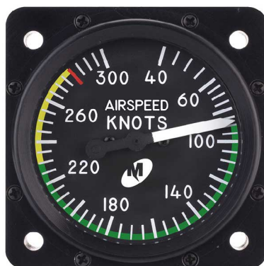
Obr. 2.4: Mechanický rýchlomer. Prevzaté z [25].
