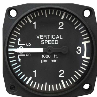
Obr. 2.5: Mechanický variometer. Prevzaté z [25].
