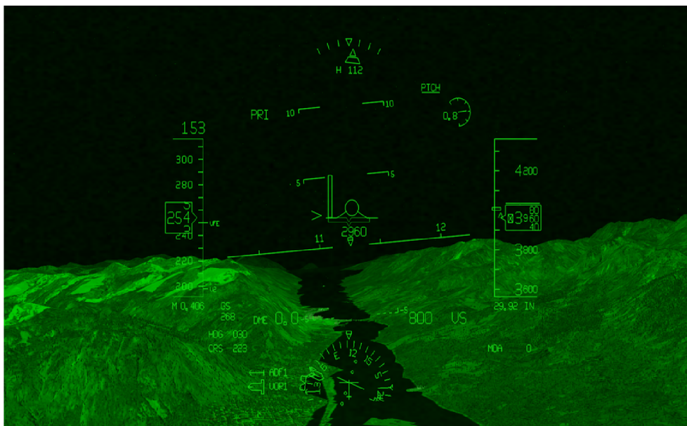
Obr. 3.6: HUD so syntetickým videním. Prevzaté z [17].
