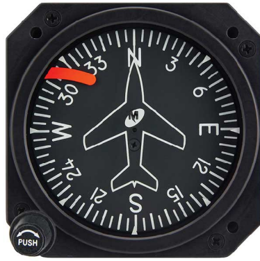
Obr. 2.7: Mechanický smerový zotrvačník. Prevzaté z [25].
