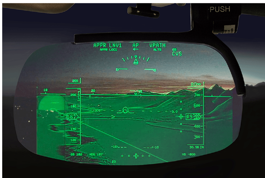
Obr. 2.2: HUD so systémom syntetického videnia. Prevzaté z [34].
