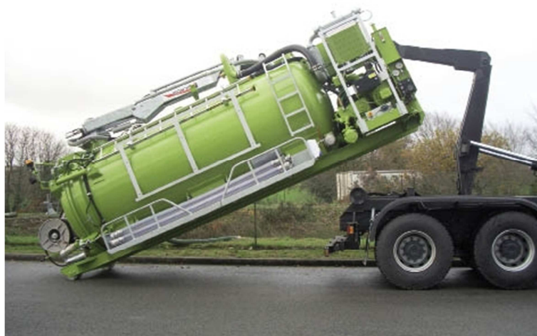
Obr. 10 Kontejnerová cisternová nástavba od firmy AgroStar Bohemia [11]
