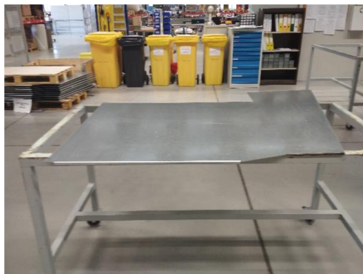
Obr. 10 Neosazená deska na mobilním pracovním stole (zdroj: vlastní)
