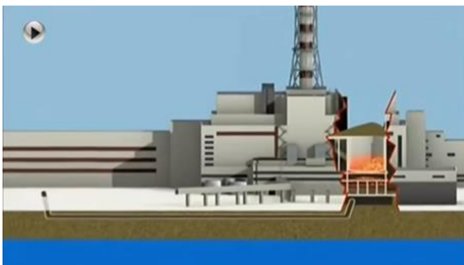
Obrázek 15: Tunel pod reaktorem. [23]
