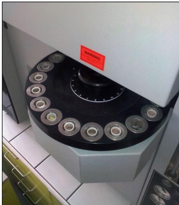
Příloha 8: Detail automatického vzorkovače Primacs SNC-100 Analyzátoru uhlíku a dusíku
