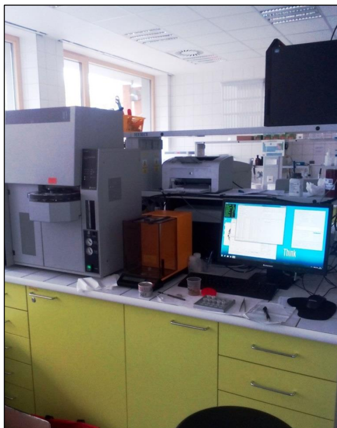
Příloha 10: Propojení Primacs SNC-100 Analyzátoru uhlíku a dusíku s počítačem – rychlý přenos dat
