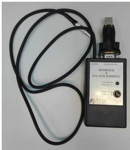
Obrázek 5-3 – Interface s izolační bariérou pro připojení Holteru [autor]
