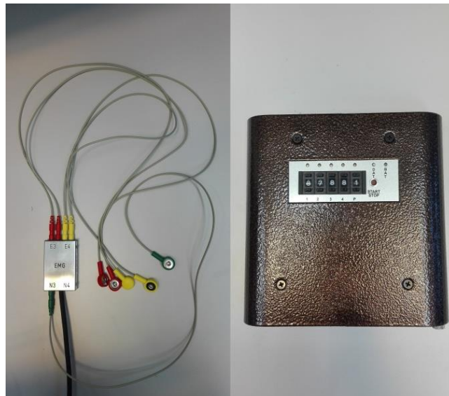
Obrázek 5-2 – Elektrody pro měření EMG a Holter [autor]
