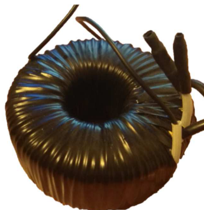
Obr. 35) Transformátor 230V => 50V
