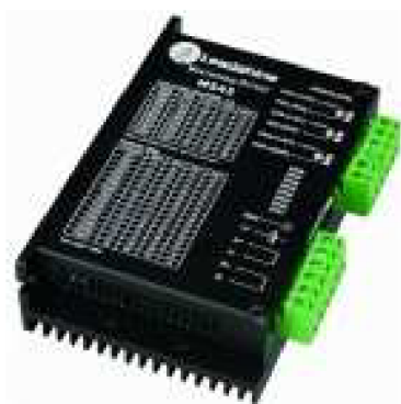
Obr. 24) Driver pro 2f krokové motory M542 [26]
