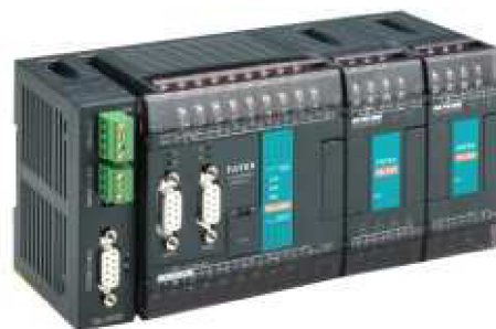
Obr. 8) Ukázka PLC automatu [10]
