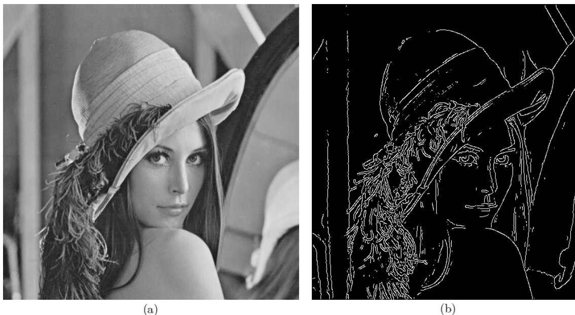
Obrázek 6: (a) Výchozí snímek. (b) Snímek po aplikaci Cannyho hranového detektoru. Zdroj: (Berkeley Robotics and Intelligent Machines Lab, 1996)
