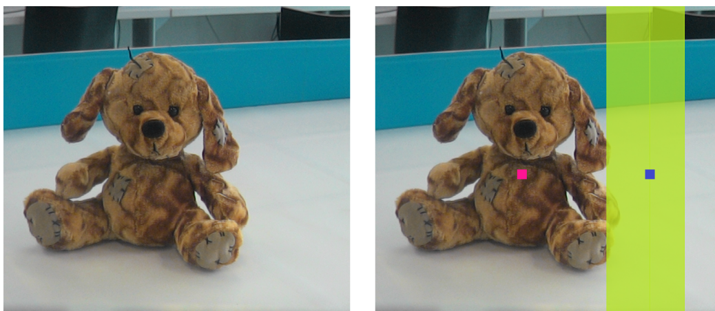
Obrázek 17: Pořízený snímek pomocí kamery a snímek po detekci těžiště, určení referenčního bodu a stanovení oblasti okolo referenčního bodu.
