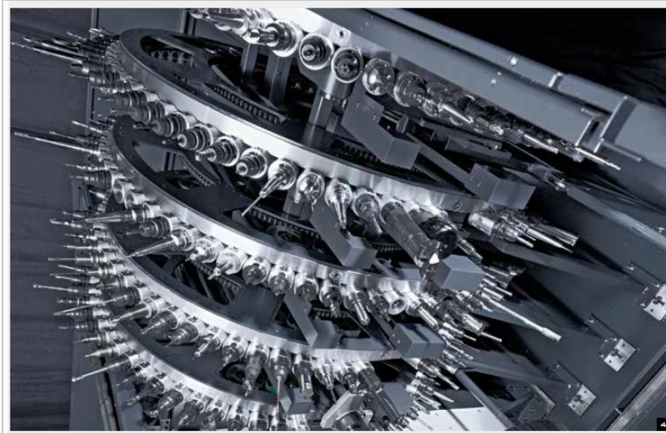
Obr. 27 Diskový násobný zásobník stroje DMG 210 P [11]
