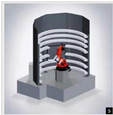
Obr. 25 Extrémní kapacita zásobníku nástrojů u stroje DMG [11]
