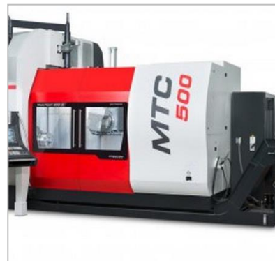
Obr. 2 Multifunkční soustružnické centrum MTC 500 [1]
