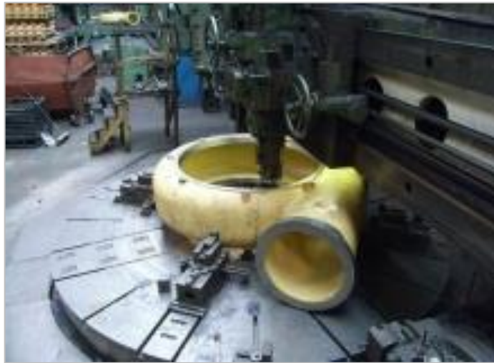
Obr. 4 Upnutí nerotačního obrobku na soustružnickém stole [4]
