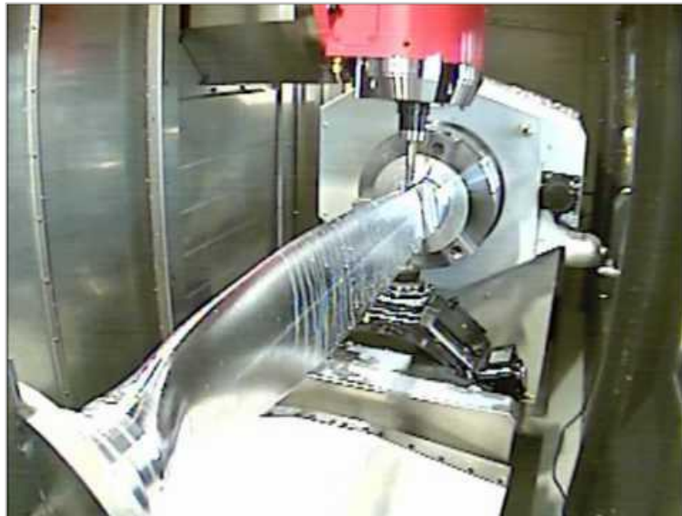
Obr. 19 4 osé obrábění vrtule [12]
