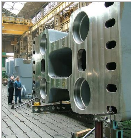
Obr. 5 Upnutí těžkého obrobku [4]
