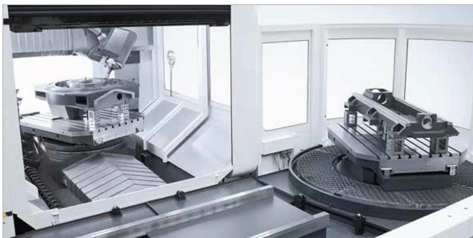
Obr. 20 Systém výměny palet na portálovém stroji DMG [11]
