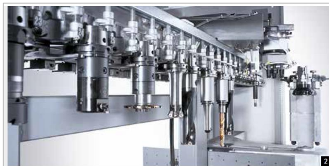
Obr. 24 Standardní řetězový zásobník nástrojů u stroje DMG [11]
