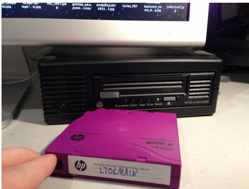
Obrázek 1: Pásková mechanika HP StoreEver Ultrium 6250 s páskou standardu LTO-6 11
