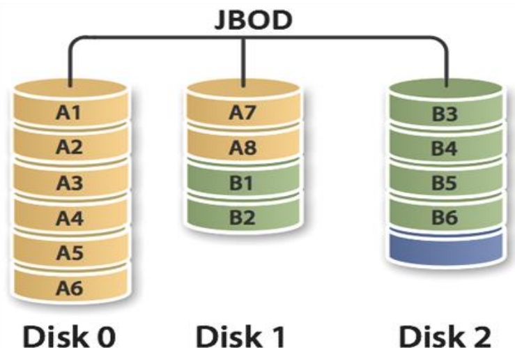
Obrázek 10: Schéma zápisu do JBOD 85
