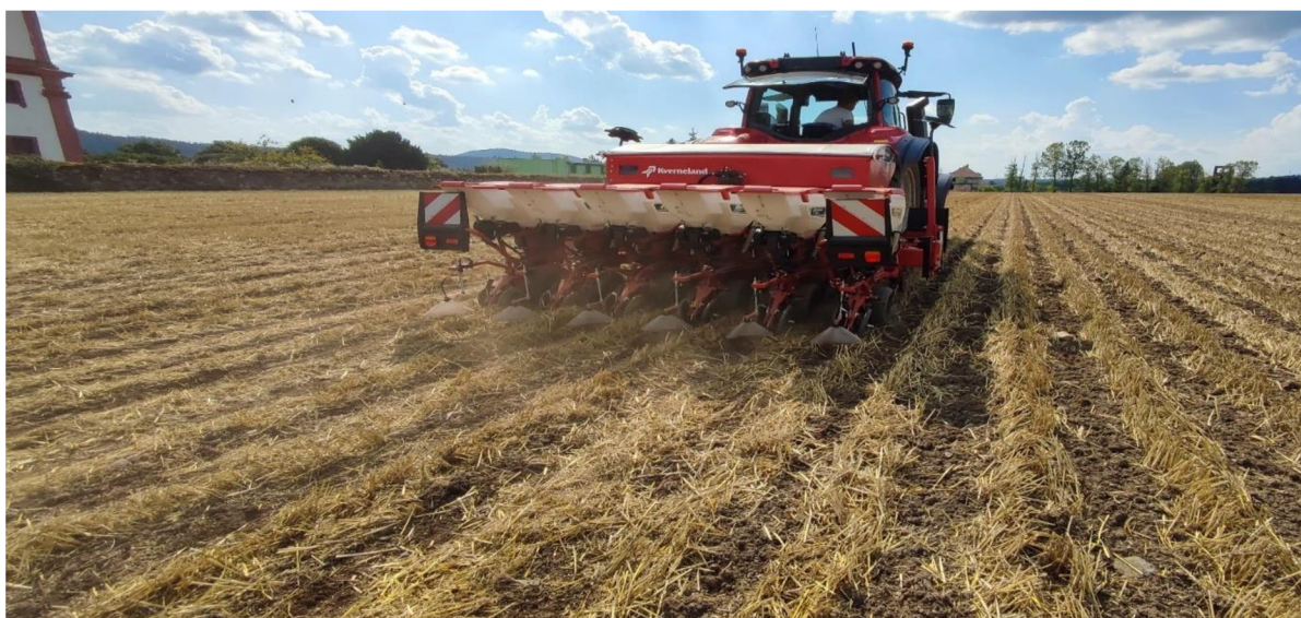
Obr. 5 Setí a preemergentní aplikace herbicidu pomocí Kverneland Optima V
