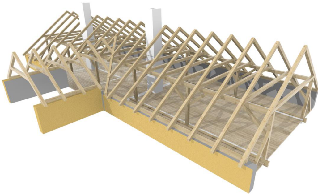
Obrázek 5: Konstrukce krovu řešeného objektu (Archicad 25 software)
