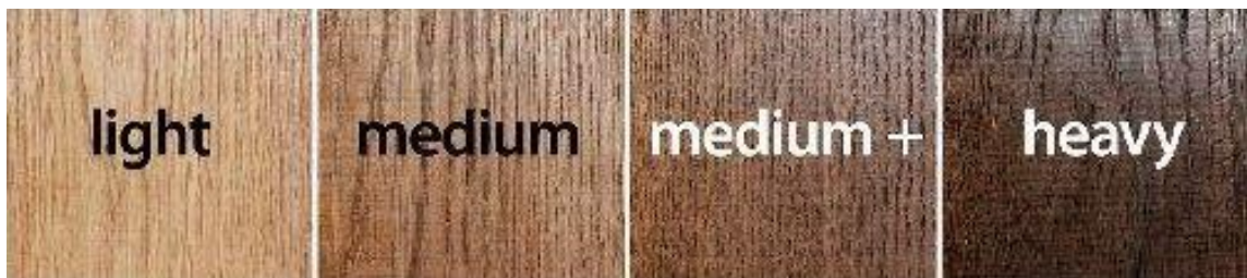
Obr. 4) Stupně opálení dřeva na škále: lehké, střední, střední plus a těžké opálení, zdroj: foto©michaelolivier.co.za.
