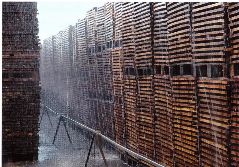
Obr. 3) Sušení dřeva přirozenou cestou, zdroj: Vinařský obzor 4/2015.
