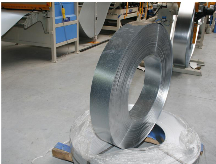
Obr. 1.5 Svitek hliníku EN AW 3005 [8].
