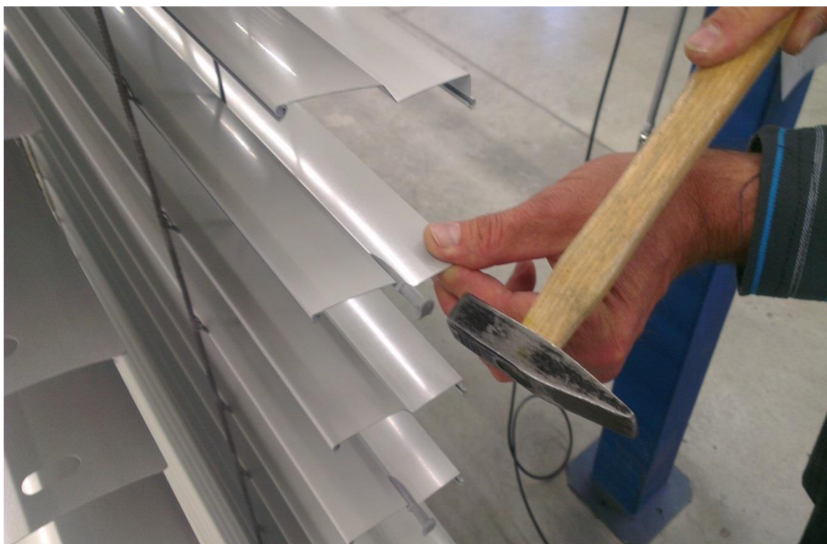
Obr. 4.2 Náplet lamel s plastovým vodítkem
